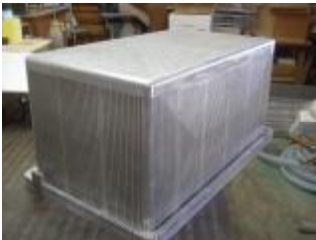
図 11 側立 4 面内外に特殊スリットを配置した金型とその成形品 (深箱本体)
